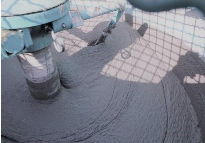
(d) Mix dispersion and homogenization
